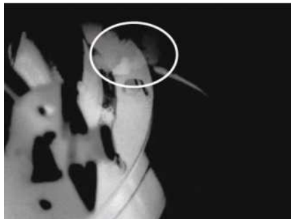
Gasfahne eines Lecks im Bild des gekühlten Detektors
