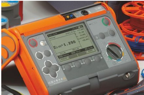
Drehwahlschalter, Funktionstasten und Grafikdisplay
