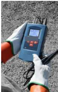
Mikroohmmeter PDRM-10A bei einer Messung vor Ort
