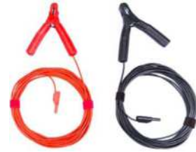
Voltage sense cables
