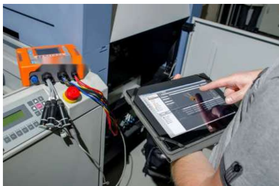
L'APQM-711 piloté depuis une tablette au pied de la machine
