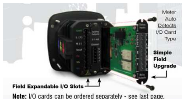
Emplacements d'E/S extensibles sur site ; l'appareil détecte le type de carte
