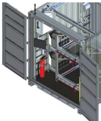
Intérieur du conteneur : bâti à deux niveaux et unités de décharge
