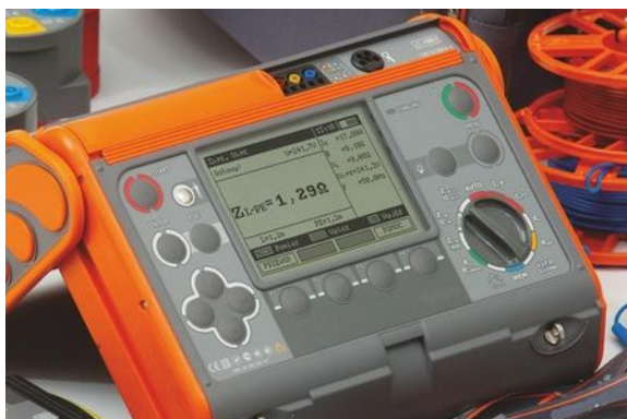
Sélecteur rotatif, touches de fonction et afficheur graphique
