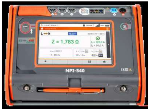
L'AMPI-540 avec son panneau tactile de 7 pouces
