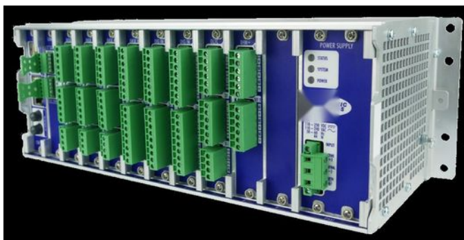
Unité de contrôle C50, avec le module de traitement principal, le module d'alimentation et les cartes d'entrées/sorties.
