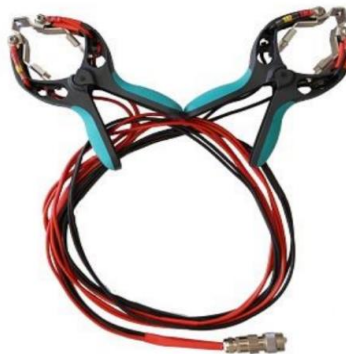
Enroulement des câbles de courant X et des câbles de capteurs avec pinces
