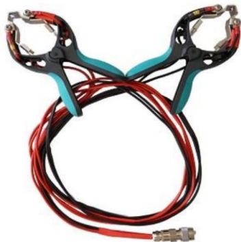
Câbles d'énergie à enroulement en H et câbles de capteurs avec pinces TTA
