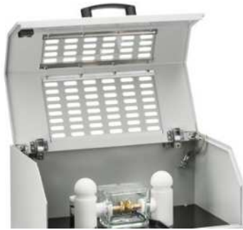
Chambre d'essai avec le récipient en verre et les électrodes
