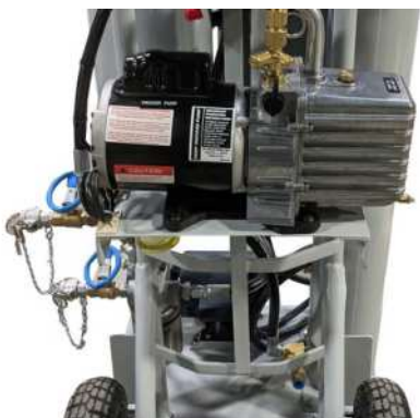
Groupe pompe à vide poussé et filtration
