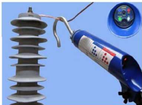
Vérification d'un parafoudre avec le PADD sur une ligne sous tension
