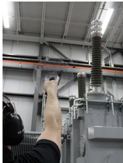
Inspection avec le capteur parabolique externe dans un poste électrique
