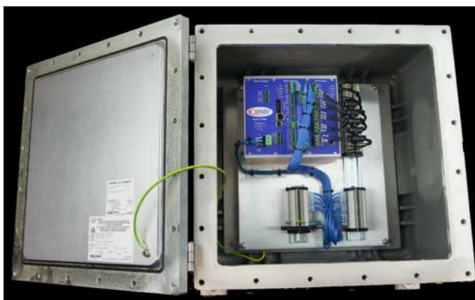
Coffret optionnel pour zones dangereuses (acier inoxydable 316)
