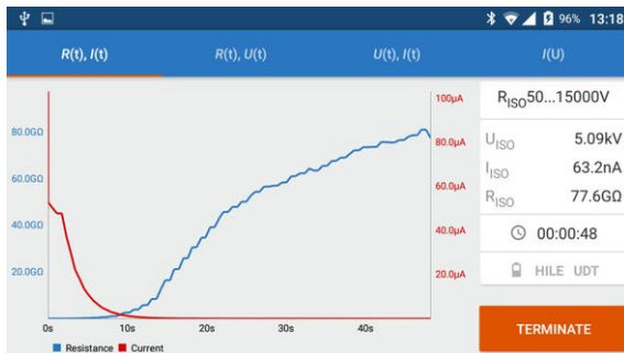
Graphiques de résistance et de courant en temps réel dans l'application mobile pendant l'essai
