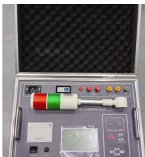
Unité de commande avec imprimante, afficheur et bornes de sortie et de mesure
