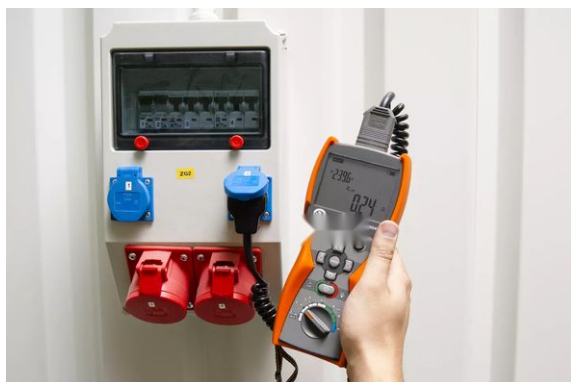
Mesure de boucle sur un tableau industriel avec l'AMZC-304
