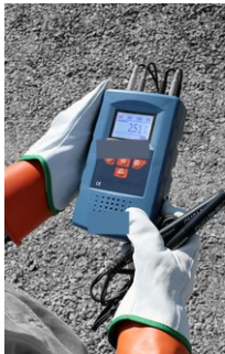
Micro-ohmmètre PDRM-10A lors d'une mesure sur le terrain
