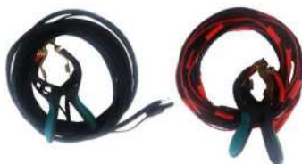
Câbles de courant et câbles de détection avec pinces TTA pour les appareils RMO-H21, RMO-H22 et RMO-H23
