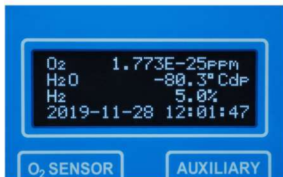
Écran OLED : O 2 , point de rosée et teneur en H 2 sur une seule vue
