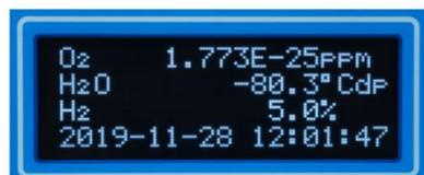
La plage de mesure du capteur s'étend à 10E-30ppm O<sub>2</sub> pour couvrir les pressions partielles d'oxygène ultra-basses dans la formation des mélanges de gaz. Le capteur est conçu pour fonctionner à des températures élevées, qui peuvent aller jusqu'à 1000°C lorsqu'on utilise l'un des tubes d'échantillonnage à insertion disponibles.
