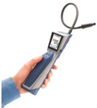
Unité portable avec sonde flexible et écran LCD
