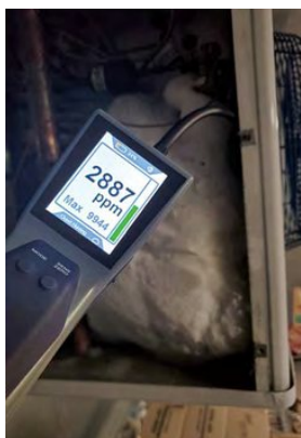
Le détecteur, avec sa sonde flexible et l'affichage de concentration
