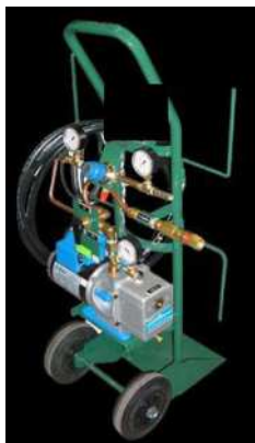
Ensemble vannes et manomètres de l'ARFU-2
