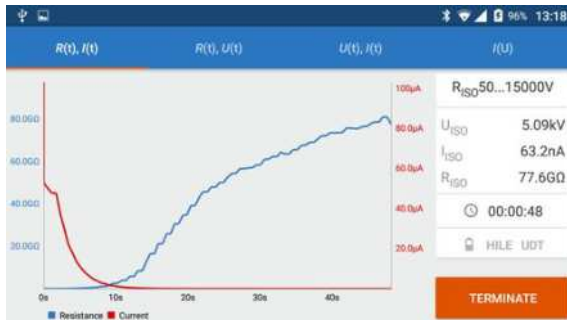
Grafici di resistenza e corrente in tempo reale nell'applicazione mobile durante la prova
