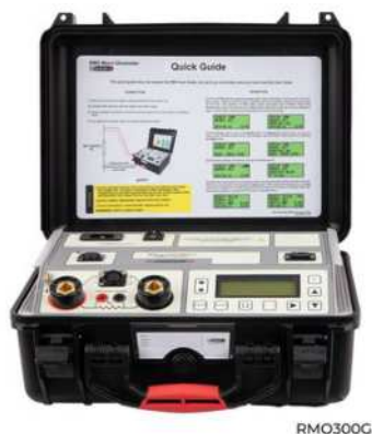
RMO300G: morsetti di corrente e di misura sul pannello frontale
