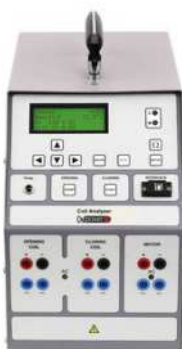
Pannello frontale: uscite bobina e motore separate con morsetti protetti contro il contatto
