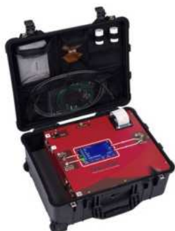
Rapidox 6100 Pump Back con tubi e sacca di accumulo gas nel coperchio
