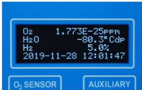
Display OLED: O 2 , punto di rugiada e contenuto di H 2 in un'unica schermata
