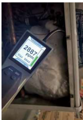
Il rilevatore, con la sonda flessibile e il display della concentrazione
