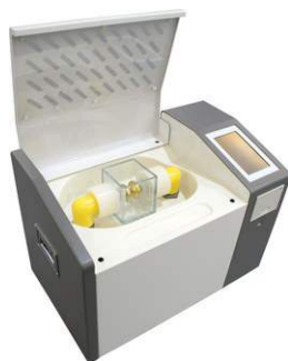
AHZJQ-X1 con la cella di prova nella camera di prova
