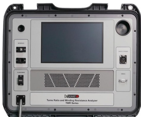
Vista frontale del TWR250B, con touch screen da 10,1".
