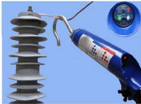
Controllo di uno scaricatore con il PADD su una linea in tensione
