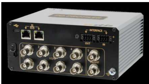
Unità di acquisizione con ingressi BNC e porte di collegamento in cascata
