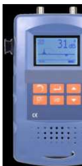
Rilevatore PXDP-II con la schermata di analisi delle scariche parziali
