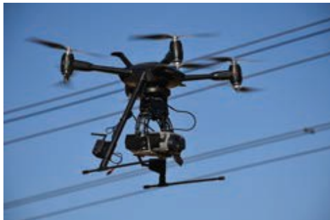
CoroCAM 6HD montata su un UAV per l'ispezione aerea
