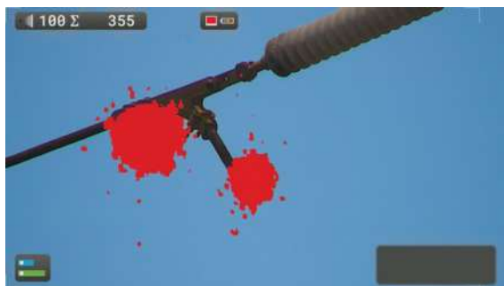
Rilevamento di una scarica corona con zoom elevato
