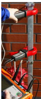
Metodo a doppia pinza: resistenza di terra senza scollegare l'impianto
