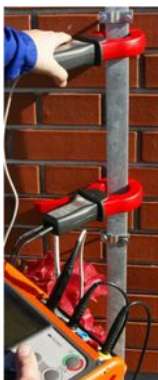
Misura a doppia pinza su un picchetto di terra, senza scollegare l'impianto
