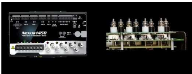
Base del equipo con las dos etapas de medida de corriente y los seis puertos de comunicación
