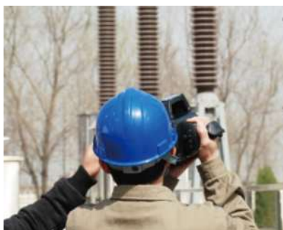
Inspección de una subestación con la instalación en servicio
