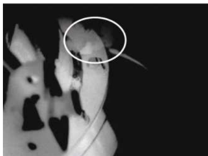
Penacho de la fuga visto por el detector refrigerado
