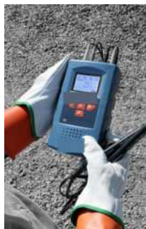
Micróhmetro PDRM-10A realizando una medida en campo
