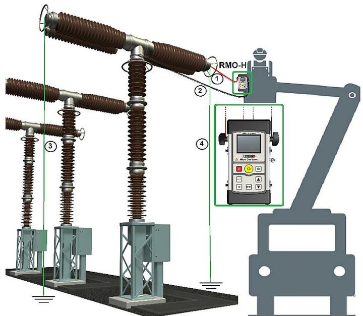
1. Cables de prueba cortos (cables de corriente y de "voltage sense" etiquetados con color rojo)
