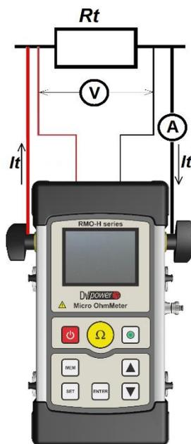
Para la medición de la resistencia de contacto de un interruptor de media tensión con el RMO-H, es conveniente utilizar los cables con la misma longitud. Los cables con sondas de Kelvin (con botón de disparo) están especialmente diseñados para esta aplicación.
