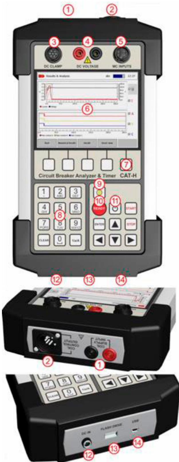
**1 - Entrada de alimentación de bobina** Entrada de alimentación de tensión para el control de la bobina.
