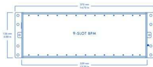
Bastidor BPM de 9 ranuras: 375 × 126 mm de panel frontal (14,75 × 5,00 in) y 339 mm en la cota inferior (13,35 in), con la misma profundidad de 143 mm (5,62 in).
