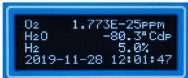
El rango de medición del sensor se extiende hasta 10E-30ppm de O<sub>2</sub> para cubrir las presiones parciales de oxígeno ultra bajo en la formación de mezclas de gases. El sensor está diseñado para funcionar a altas temperaturas, que pueden extenderse hasta 1000°C cuando se utiliza uno de los tubos de muestra de inserción disponibles.
