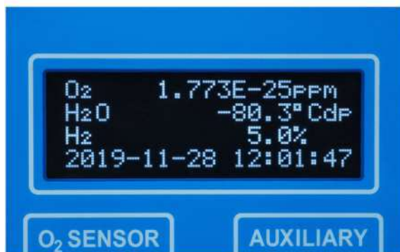
Pantalla OLED: O 2 , punto de rocío y contenido de H 2 en una sola vista
