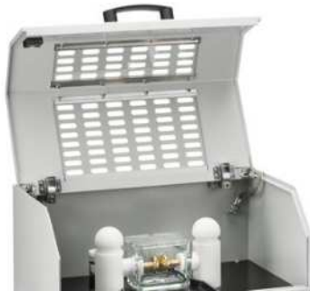
Cámara de ensayo con el recipiente de vidrio y los electrodos
