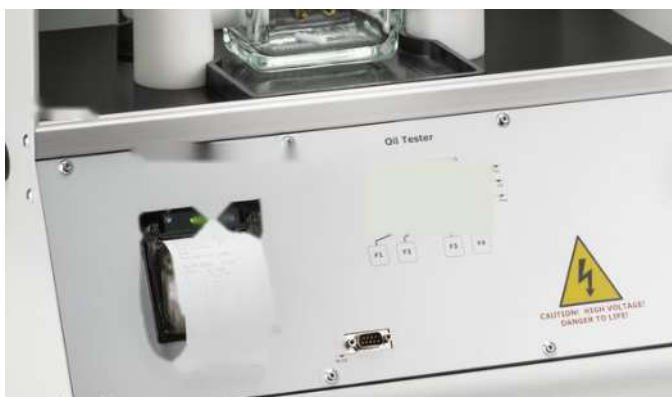
Impresora térmica integrada y display gráfico del panel
